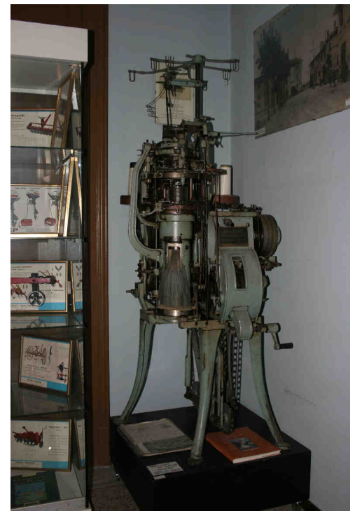
Fig. 24 - Macchina utilizzata per la lavorazione della calze
