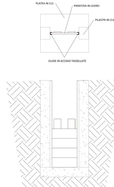
**PIANTA E PROSPETTO PARATOIA IN ACCIAIO TIPO - 1:20**
